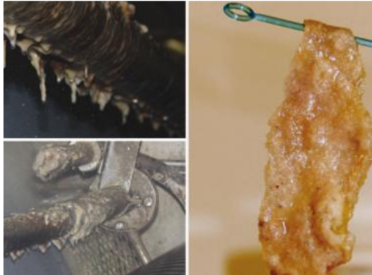
Abbildung 1: Schleimablagerungen an Teilen der Papiermaschine (links); abgelöster Schleimbatzen (rechts)
