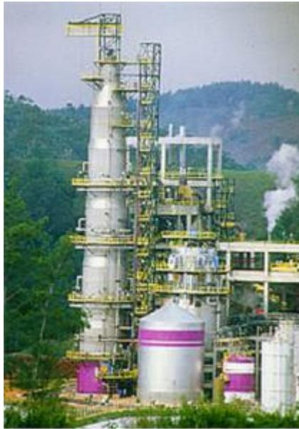
Abbildung 7: Vertikaler, kontinuierlicher Zellstoffkocher (Andritz)
