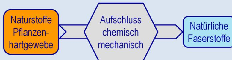
Der Faserstoff, der im Wesentlichen durch mechanisches Zerschneiden des Holzes hergestellt wird, nennt sich einfach „Holzstoff“, zerfasert man das Holz überwiegend durch Kochen in bestimmten Chemikalien, erhält man einen sehr reinen Faserstoff, den „Zellstoff“.
