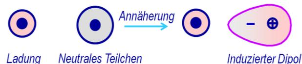
Abbildung 4: Entstehung eines induzierten Dipols
